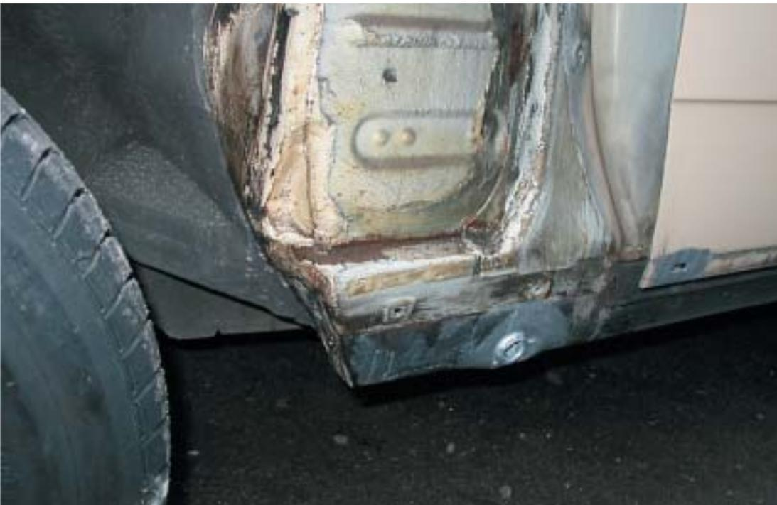
Diese Anzeichen verbergen am dahinterliegenden Schwellerkopf und der A-Säule zumeist größeres Unheil
