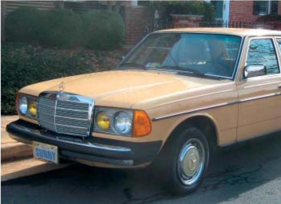
Die US-Version – überwiegend als Diesel mit überdimensionalen Stoßstangen und Sealed-Beam-Scheinwerfern
