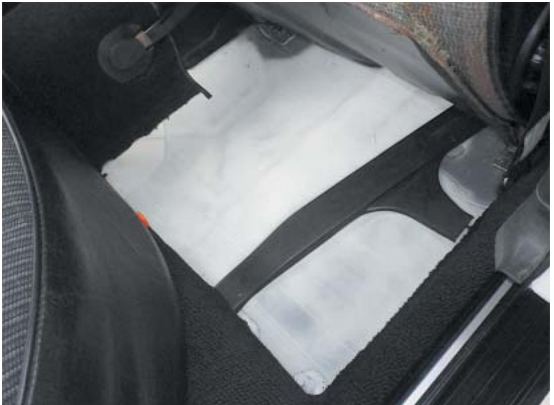
Hier der Querträger vorne unter dem Vordersitz – bei herausgenommenen Bodenteppichen lässt sich der Zustand prüfen (Abbildung mit demontiertem Sitz)
