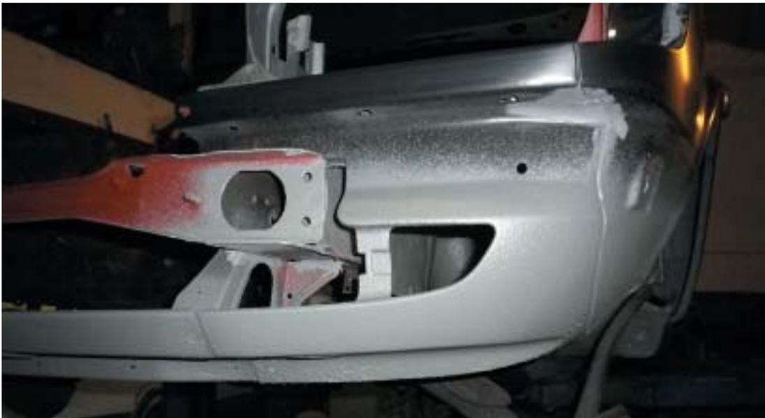
Nahtstelle an einem neuen Kotflügel, hier frisch abgedichtet und mit Steinschlagschutz versehen
