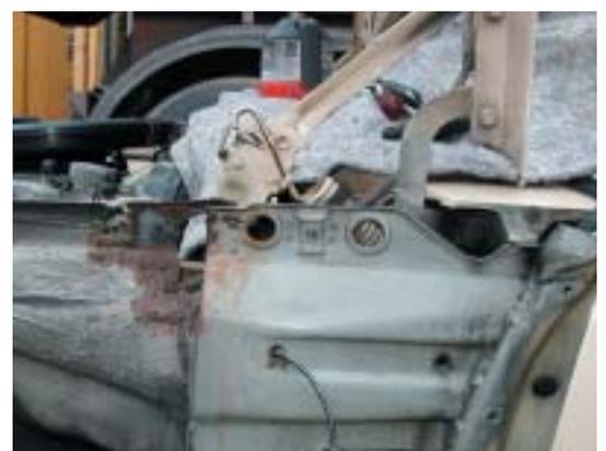
Hier ein typischer Korrosionsschaden im Haubenscharnierbereich (bei abgenommenem Kotflügel)
