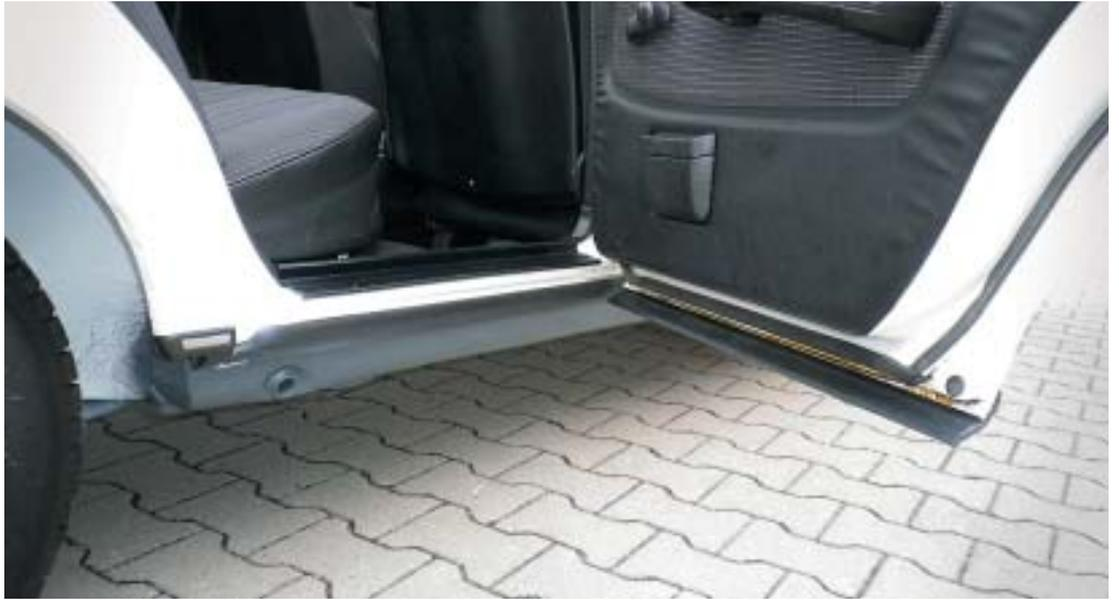
Beginnende Korrosion am Übergang Radlauf zum Schweller hinten (Beispiel Limousine/T-Modell)
