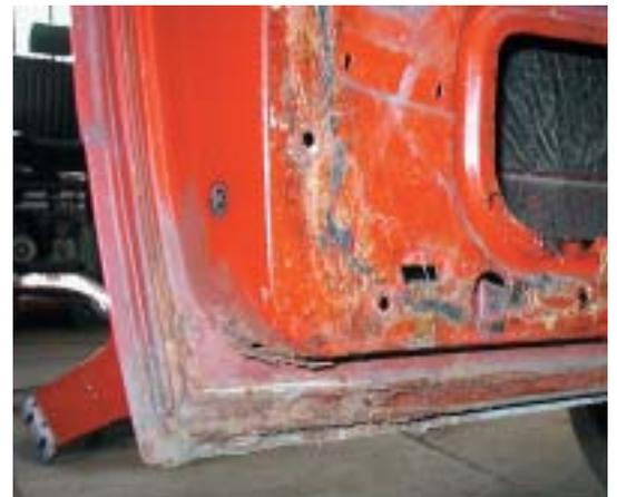
Eine Türunterkante im Sollzustand. Das Gelbbraune ist Korrosionsschutz.
