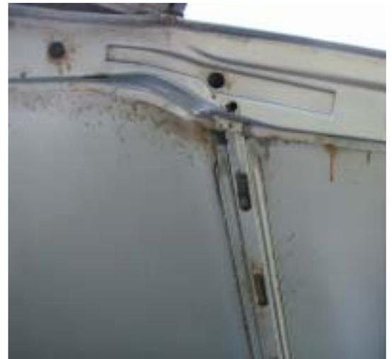
Rechts: Die Motorhaube sollte an den Blechfalzen, Ausschnitten und Verstärkungen auf Rost kontrolliert werden. Speziell an der Vorderkante rostets gerne. Hier ein gutes, frisch mit Wachs konserviertes Beispiel
