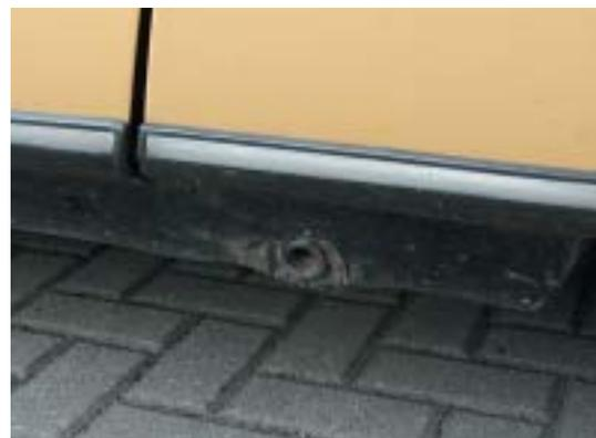
Im Schwellerbereich sollte auf Schäden durch „Aufsetzer“ oder falsch angesetzte Hebewerkzeuge geachtet werden
