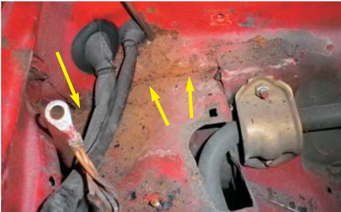
Die Naht zwischen Innenradhaus und Stirnwand unter dem Batterieblech rostet ebenfalls gerne, wenn die Abläufe nicht sauber gehalten werden und eventuell Batteriesäure ausgetreten ist.
