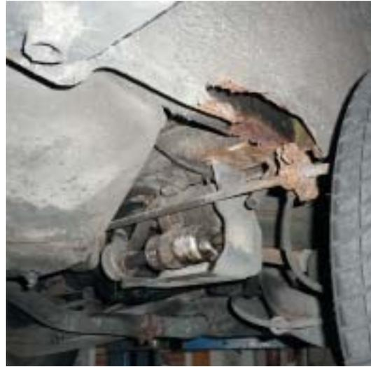
Der hintere Längsträger rostet meist an der unteren Kante, am Blechfalz zum hinteren Innenradhaus.
