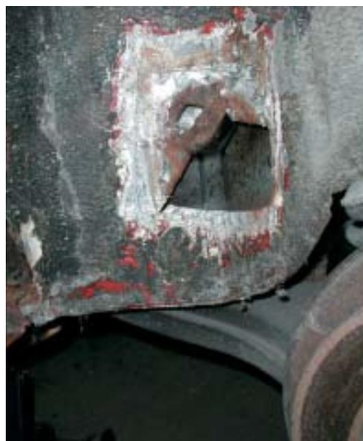
Im hinteren Radhaus sind über der Achse mehrere Gummistopfen, die den Längsträger verschließen. Diese bieten der Korrosion ebenfalls einen Angriffspunkt. Als »zeitwertgerechte Reparatur« kamen meist aufgesetzte Blechflicken zum Einsatz, hier links gut zu erkennen...
