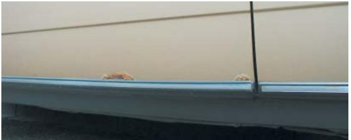
Ohne Gnade frisst sich der Rost nach innen und befällt nach dem unteren Türfalz die Innenseite der Türe und das Aufnahmeprofil der Türdichtung
